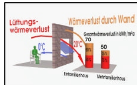
Bild 2: Lüftungswärmeverluste bei Ein- und Mehrfamilienhaus nach WSchVO 95
